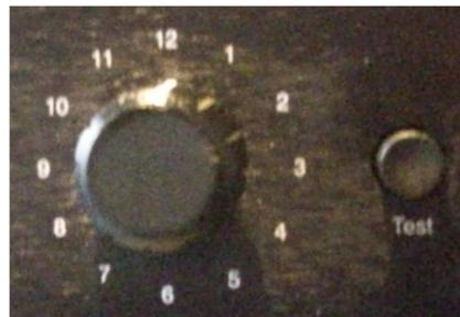
Jeder Kanal hat eine Testtaste. Mit dem Wahlschalter wählt man den Kanal an der für Testzwecke geschaltet werden soll.
