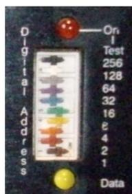
Die Adresse des DMX Start-Kanals wird über DIP-Schalter am Gerät eingestellt. Damit die Steuersignale richtig an das Switch-Pack adressiert werden, müssen sie die DIP-Schalter entsprechend untenstehender Tabelle einstellen.
